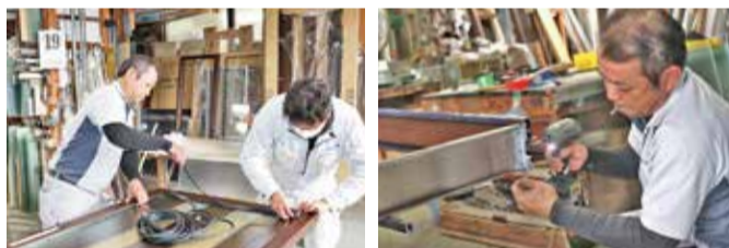
(上) サッシ枠に合わせて専用のカッターでガラスをカット。 (左) サッシ枠のサイズは依頼主の要望に合わせて自在に調整します。 (右) サッシ枠にはめたガラスを固定するために、ゴムを埋めていきます。
