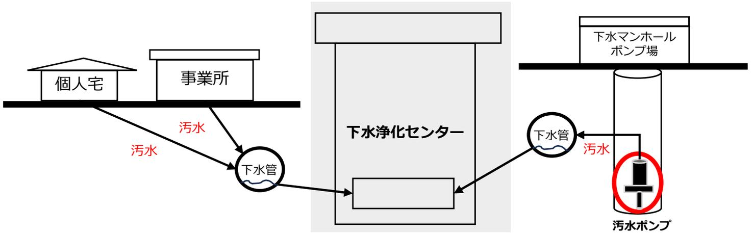
各家庭や事業所から出た汚水は、市の管理する下水浄化センターで処理されています。下水浄化センターまで流れ込む管には自然に浄化センターまで流れる下水道管のほかに汚水ポンプを利用して下水管まで汚水を送るものがあります。下水道にプラスチック類や布巾などの繊維類を流されると汚水ポンプ内にて詰まりを起こすなどのトラブルが発生します。その度に汚水ポンプを引き上げ、分解・清掃を行なう必要があります。
